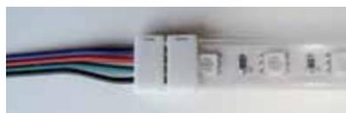
Pour une utilisation extérieure, nous vous conseillons de souder à l'étain directement les fils sur le ruban, avant de refaire l'étanchéité avec la colle et les bouchons fournis.
